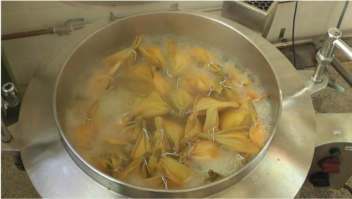
Figura 44. Detalhes do processo de cocção das pamonhas (fabrica dispõe de 3 tachos Americano em Aço Inoxidável com capacidade de cocção de 150 unidades de pamonha por tacho).
